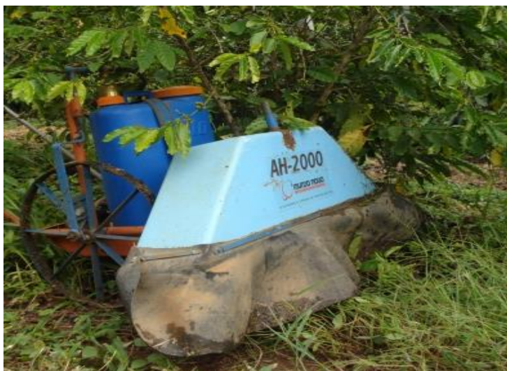
Figura 3. Pulverizador manual de herbicida no carrinho e com acessório “chapéu de Napoleão” para controle da deriva.
