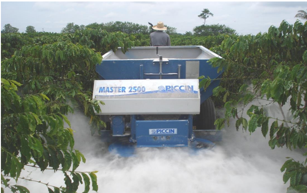
Figura 4. Calagem em lavoura de C. canephora 'Conilon' plantado com espaçamento de 3 m entre linhas e com três anos de idade.
