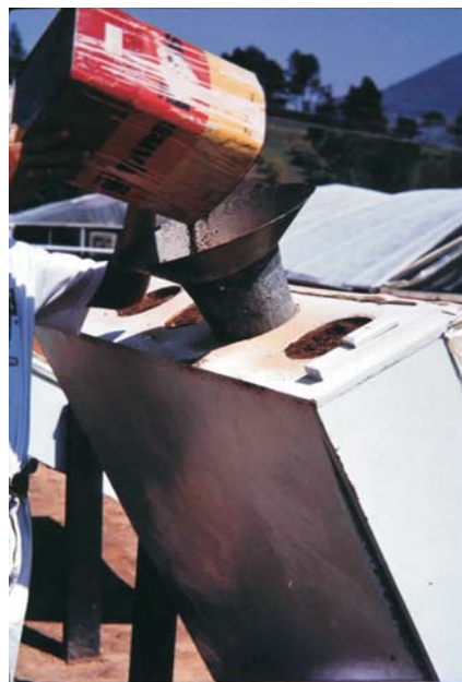
Fig. 3. Colocação do substrato no coletor solar com auxílio de um funil.
