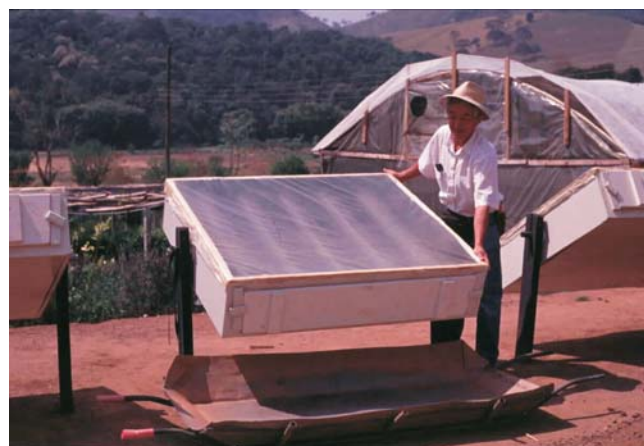
Figura 4. Retirada do substrato do coletor solar com auxílio de uma padiola.
