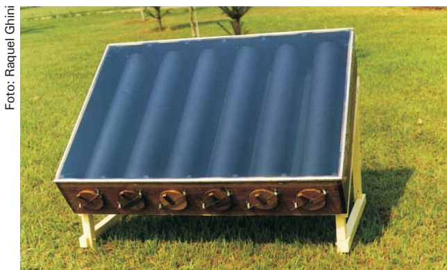
Figura 1. Coletor solar utilizado para a desinfestação de substrato.
